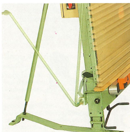
Verschieberost 1265 damit ein Beschädigen der Anlageleisten im Horizontalschnitt verhindert wird. Per Hebelmechanik verschieben Sie den Auflagerost nach unten (als Sonder- zubehör auch automatisch wie bei 1270).
